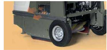
O ar aspirado é libertado através de grelhas localizadas numa zona alta da máquina. Isto significa que nenhum do pó que assentou na superfície em redor da máquina é levantado, garantindo assim excelentes resultados de limpeza.
