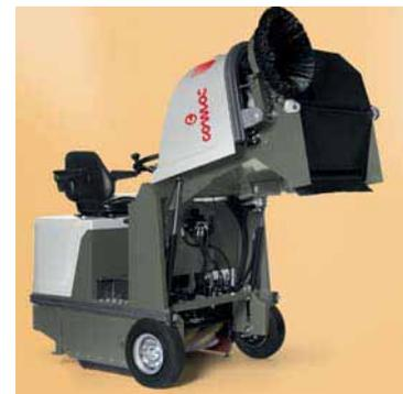
A pressão e ajuste da altura da escova central controlam-se de forma muito simples, apenas tem de regular a maçaneta junto à escova. O ajuste da altura da escova, em função do desgaste desta, pode igualmente ser feito com muita facilidade. Esta operação permite assegurar um ciclo de vida prolongado da escova.
