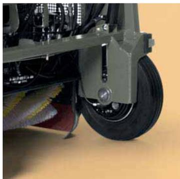
Além de reduzir o stress mecânico, as rodas de grande diâmetro tornam a operação de varimento mais confortável. O seu suporte de estrutura firme, permite-lhe manter características operativas de resultados constantes e sempre idênticos. Ambas as versões têm travões controlados de forma hidráulica como atributo standard.
