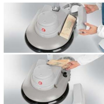
CM1500V com aspiração. O saco de papel para a recolha do pó pode ser retirado e substituído de modo simples, pois é facilmente acessível
