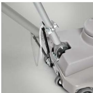
Mola de gás que permite manter constante a pressão da escova sobre o pavimento, independentemente da posição da barra de tracção. Isto evita queimar e estragar a superfície que está a ser tratada
