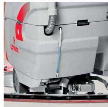
Um pequeno tubo muito prático, foi colocado na traseira da máquina para que possa visualizar durante toda a operação de limpeza os níveis de água limpa do tanque
