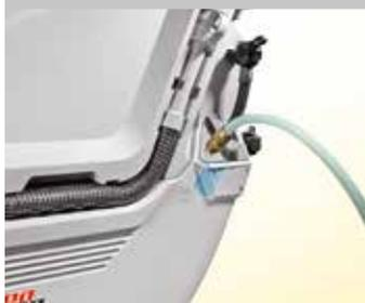
Um dispositivo simples (opcional) permite o enchimento rápido do tanque com água limpa, sem a presença do operador
