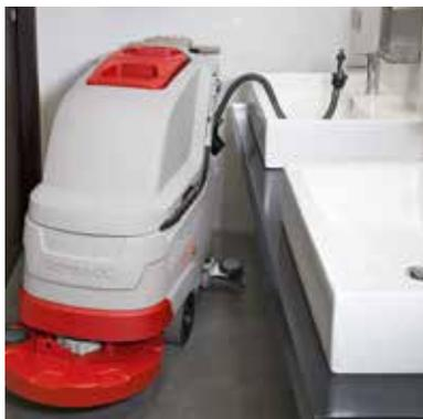
A mangueira para o enchimento do tanque de solução pode ser ligada diretamente a qualquer torneira de água, dando a possibilidade de abastecer a máquina em qualquer lugar e tornando a operação mais rápida.
