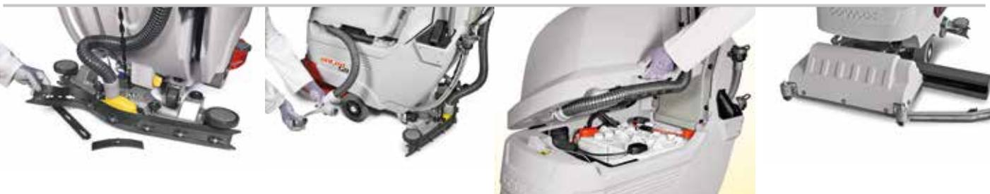
A substituição ou rotação das lâminas de borracha faz-se em alguns segundos sem utilizar ferramentas
