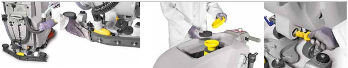
Para assegurar uma perfeita secagem é importante que o tubo de aspiração e o rodo das lâminas de borracha devam ser limpos no final de qualquer operação de limpeza. O rodo pode ser levantado para limpar rapidamente as lâminas de borracha
